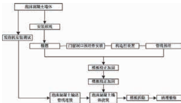
圖1 輕質混凝土現澆牆體施工工藝圖
